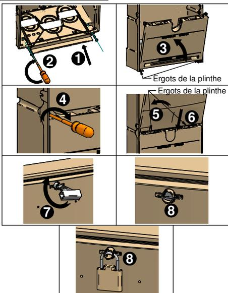
Mettre en place les ergots de la plinthe dans le socle puis basculer la plinthe **3**.
