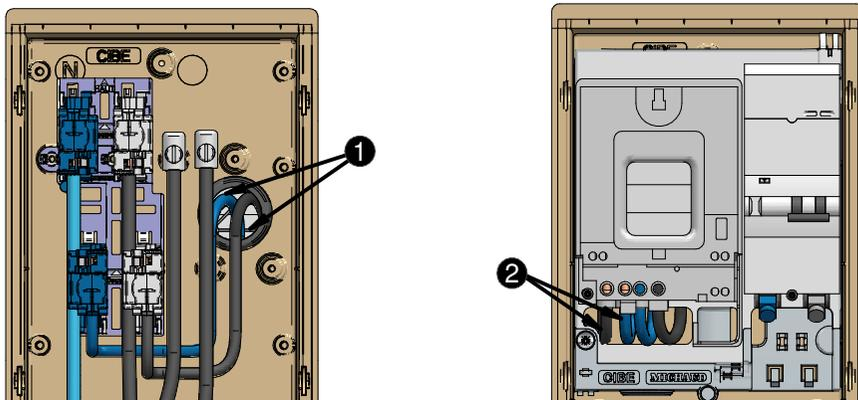
NOTE : Pour un compteur LINKY les câbles sont raccordés par le bas.
