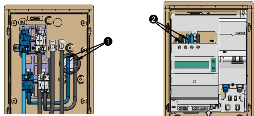
NOTE : Pour un compteur LINKY les câbles sont raccordés par le bas.
