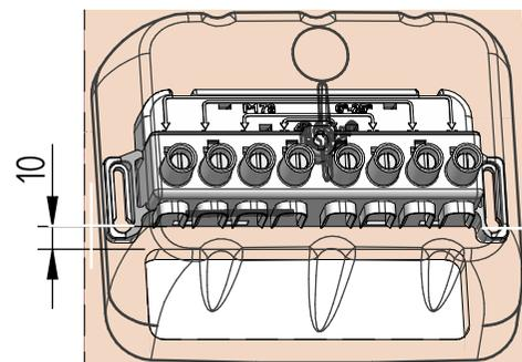
1. Positionner le dispositif sur le panneau en respectant la cote de 10mm maximum.
