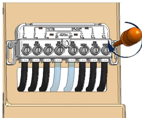
1. Accrocher le bornier sur les deux vis prémontées.
