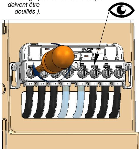
4. Vérifier que chaque conducteur soit en butée au fond de la borne puis serrer à 4 Nm.
